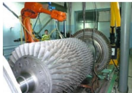
Ремонт оборудования на роботизированном лазерном комплексе
